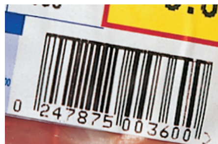
Figuur 7: Barcode afgekeurd op parameter Defects (gaatjes)
