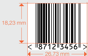
Bij de nominale afmetingen van de EAN-8 barcode (100%)
